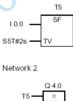
زمانیکه **SIGNSL STSTE** از ۱ به ۰ تغییر کند تایمر بکار می افتد و اگر از ۰ به ۱ برود **TIMER** ری استارت می شود **Q4.0** زمانی ۱ است که یا **IO.0** یک باشد یا تایمر در حال کار باشد.
