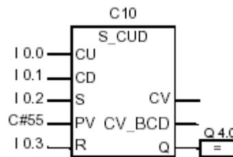
در شمارنده فوق با تغییر سیگنال از ۰ به ۱ در  $I0.2$  SET می شود.  $C\#55$  یعنی مقدار شمارش تا ۵۵ دفعه می باشد. هنگامی که  $I0.0$  از ۰ به ۱ تغییر کند شمارنده به صورت افزایشی تا ۹۹۹ به بالا می شمارد. و اگر  $I0.1$  از ۰ به ۱ تغییر کند به صورت کاهش تا ۰ می شمارد. هنگامی که  $I0.3$  از ۰ به ۱ تغییر کند مقدار COUNTER در ۰ ست می شود.
