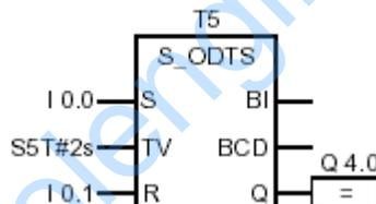
وقتی که I0.0 از ۰ به ۱ (لبه بالا رونده) تغییر حالت دهد تایمر بر خلاف تغییر سیگنال عمل میکند یعنی اگر I0.0 از ۰ به ۱ تغییر حالت پیدا کند بعد از گذشت زمان T تایمر RESTART می شود و اگر در زمانیکه تایمر کار میکند I0.1 از ۰ به ۱ تغییر وضعیت دهد تایمر RESTART می شود. و Q4.0 در زمانیکه زمان تایمر تمام شده و I0.1 صفر است روشن است.
