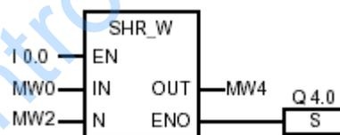
با ۱ شدن I0.0 فعال می شود و محتویات MW0 را به تعداد بیت موجود در MW2 به صورت WORD به سمت راست شیفت می دهد و نتیجه را در MW4 میریزد.
