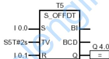
اگر I0.0 از ۱ به ۰ تغییر کند تایمر بکار می افتد و Q4.0 زمانی ۱ است که I0.0 یک باشد یا تایمر در حال کار باشد و I0.1 اگر در زمان کار کردن تایمر فعال شود تایمر RESTART میشود.
