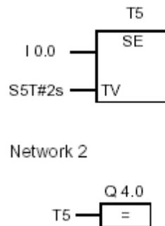
اگر I0.0 از ۱ به ۰ تغییر کند تایمر بکار می افتد و بدون تاثیر از لبه پایین رونده ادامه می یابد و اگر I0.0 بعد از اتمام TIME فعال شود تایمر RESTART می شود.
