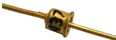
دیودهای معمولی اتصال PN، نمی‌توانند خیل سریع قطع و وصل شوند. برای بالا بردن سرعت قطع و وصل در یک دیود به عنوان مثال چند میلیارد بار در ثانیه از دیودهای شاتکی استفاده می‌کنند. دیودهای شاتکی از نیمه هادی و فلز ساخته می‌شوند و به علت قابلیت هدایت الکتریکی زیاد فلز، زمان تاخیر این نوع دیودها بسیار کم است.
