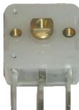
این خازنهای بسیار کوچک اند و در مدارها بكمک پیچ گوشتی می توان آنها را تنظیم کرد. با تغییر دادن فاصله بین صفحات ، ظرفیت خازن تغییر می کند . ماده عایق این خازنهای معمولاً میکا یا سرامیک است . از این خازنهای در فرکانس های بالا استفاده فراوان می شود.
