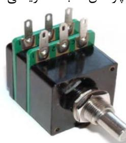
رئوستا یک سنسور دو سیمه است که از یک مسیر مقاوتی تشکیل شده که به پتانسیل الکتریکی (مثلاً ۱۲ ولت) متصل است و بر روی آن یک پایه مکانیکی حرکت می کند. از رئوستا معمولاً به سه طریق استفاده می شود.
